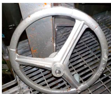
折損した手動操作ハンドル
