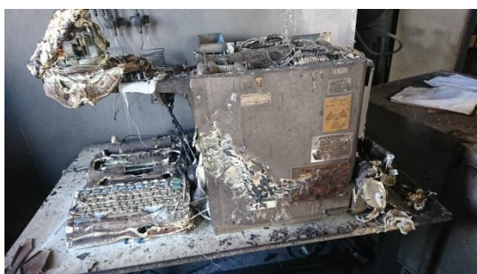
写真1. 焼損したガスクロマトグラフの状況
